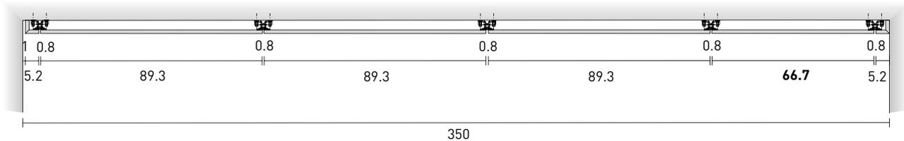
Nel calcolo dimensionale in altezza, è necessario considerare 1 cm di tolleranza. Il montaggio degli schienali avviene frontalmente con le apposite clip a pressione.
