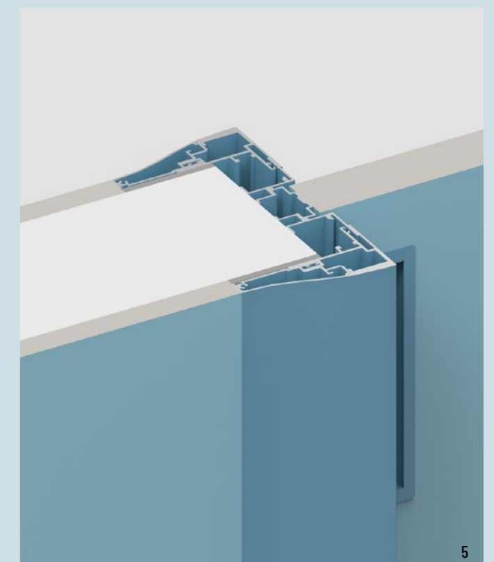
5. Sezione orizzontale porta Morbida a scomparsa con pannelli Boiserie a incollaggio, lato di battuta 5. Horizontal section Morbida pocket door with Boiserie gluing panels, stop side
