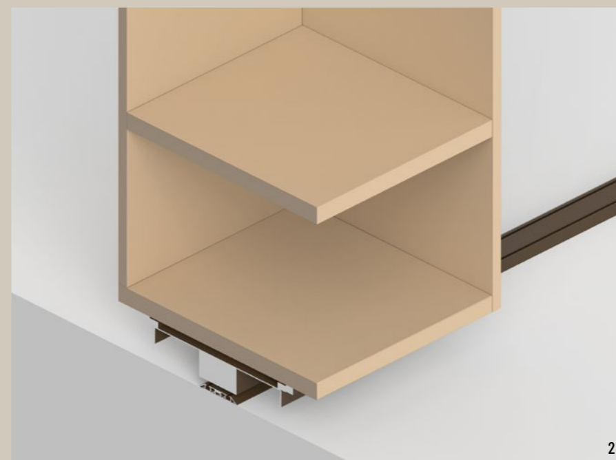
2. Sezione verticale libreria Girevole, binario inferiore 2. Vertical section Girevole bookcase, lower rail
