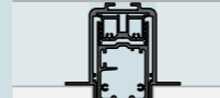
Binario Evo a soffitto a 1 via con trave da incasso 1 way ceiling Evo rail with built-in system
