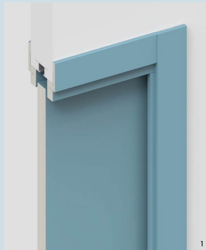
1. Sezione verticale Stipite legno con And a scomparsa 1. Vertical section Wooden jamb with And pocket door
