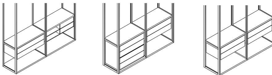
Le cassettiere sono completate da un retro pannello in tinta con la struttura se inserite in un modulo Teatro con schiena vetro **(A)** o senza schiena **(B)**.
