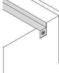
I comò di larghezza pari o superiore a 120 cm sono provvisti di una barra in metallo, posizionata sotto al cappelletto, con sistema di regolazione per un corretto allineamento.
