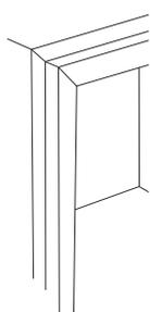
È realizzata con pannelli in particelle di legno Sp 1.8 cm tagliati a 45°, giuntati con soluzione di continuità e rivestiti con:
